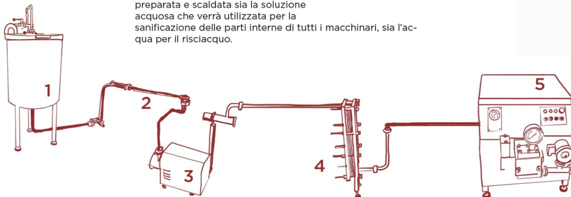
Il latte quindi non 'passa' per il CIP, ma dal **tubo** che vedete in basso all'angolo della stanza (2), tramite una **pompa (3)**, viene spinto verso la **piastra termica (4)** dove viene scaldato prima della lavorazione.
